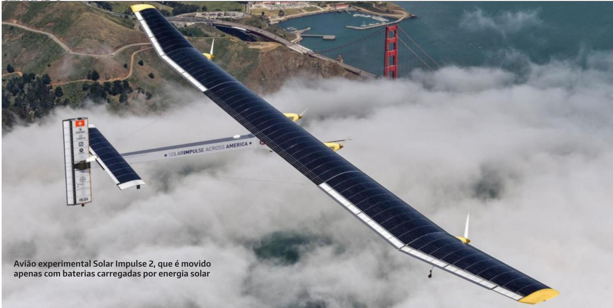
Avião experimental Solar Impulse 2, que é movido apenas com baterias carregadas por energia solar
